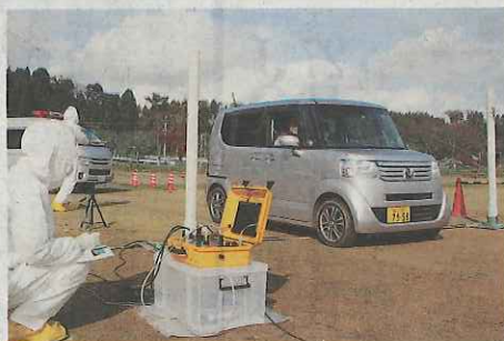
タイヤの放射線を測るポ ール形の測定機＝富山県 氷見市の十三中学校で
